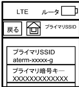
1.3.2 デスクトップ画面右下のアイコンなどから「ワイヤレスネットワーク接続」を立ち上げ、ご購入の AtermMR03LN の SSID の値（11 桁の数字・アルファベット混じり）を選択し、「接続」をクリックします。AtermMR03LN の SSID の値は STEP1.3.1 の方法でご確認ください。
